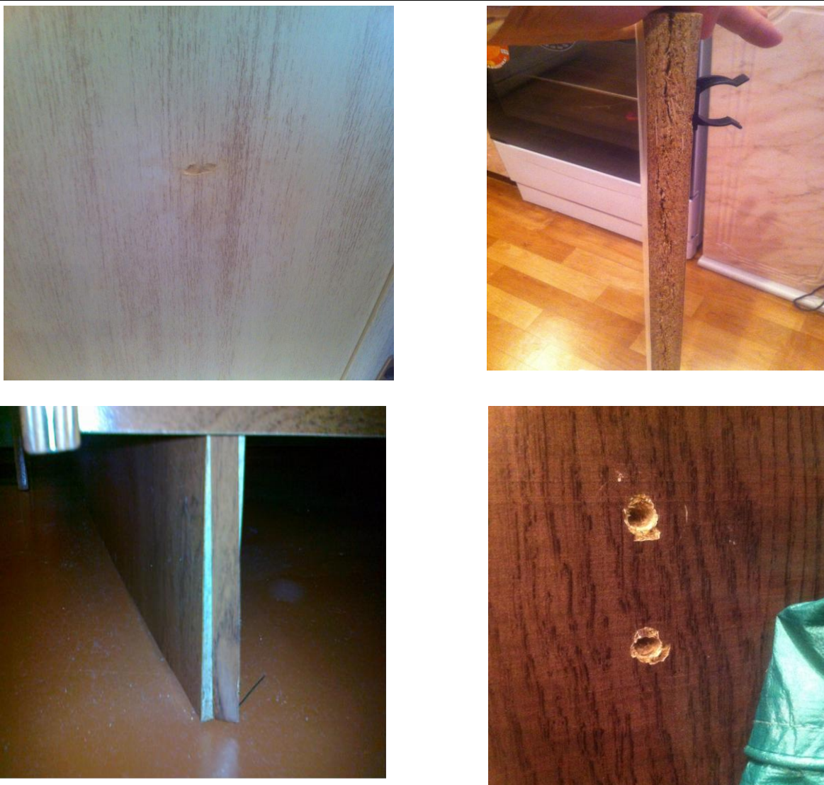
Рис. 1 – Характерные дефекты корпусной мебели
